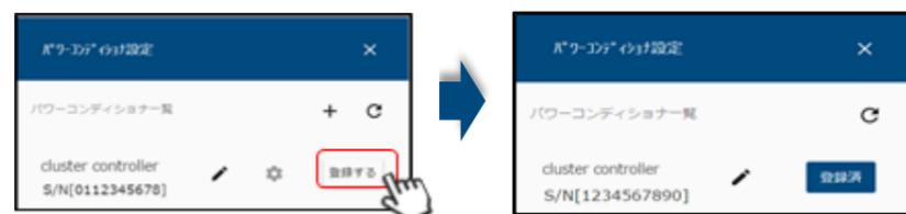
検索で見つからない場合、クラスターコントローラの電源の OFF/ON と、「3-3 パワーコンディショナ(クラスターコントローラ)を設定する」の設定が正しく保存されているか改めてご確認下さい。
