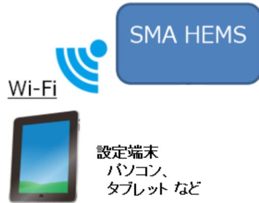
端末から本製品のアクセスポイントに無線 LAN 接続します。
